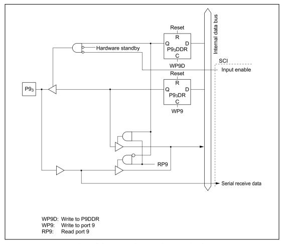
Figure C.9 (d) Port 9 Block Diagram (Pin P93)
