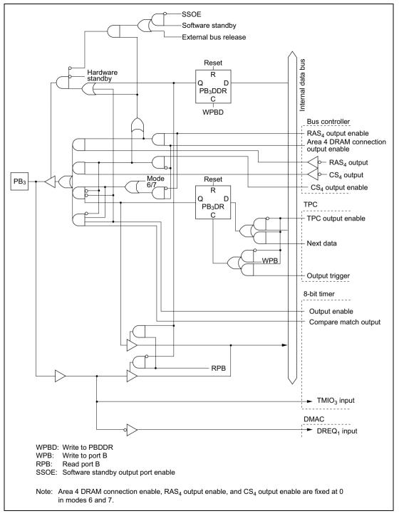
Figure C.11 (d) Port B Block Diagram (Pin PB<sub>3</sub>)
