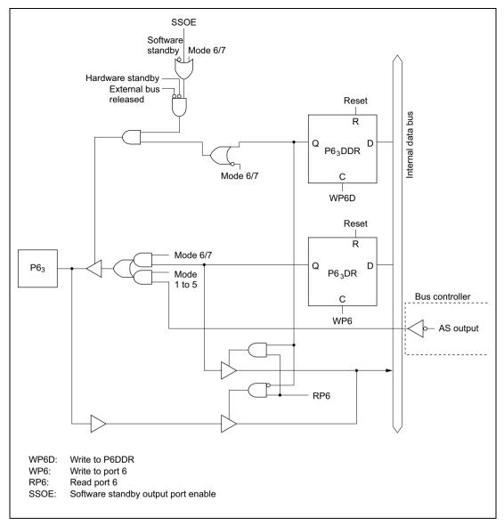
Figure C.6 (d) Port 6 Block Diagram (Pin P63)
