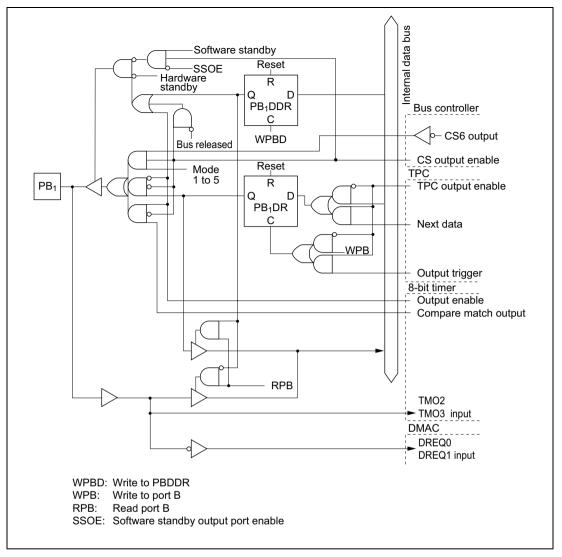
$Figure\ C.11\ (b)\quad Port\ B\ Block\ Diagram\ (Pin\ PB_1)$
